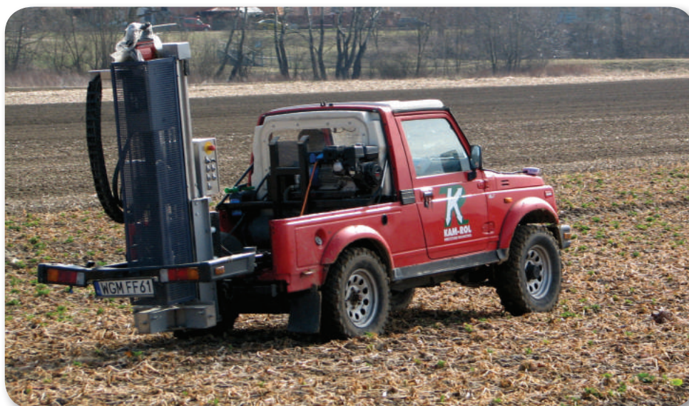
Fot. 2. Pobór próbek gleby próbnikiem pneumatycznym z GPS
